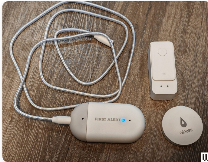
شکل ۲) آب‌یاب هوشمند اولین قطره‌ها را زیر سینک و لباسشویی می‌گیرد.
